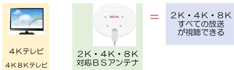
※ アンテナ本体及びミキサー・ブースター・分配器・分岐器・直列ユニット・分波器・ケーブル等を4K8K対応の製品に取り換える必要があります。（地デジアンテナと接続することで各室でテレビ放送を楽しむことができます）
